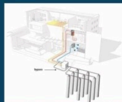
Principe d'une installation de géothermie qui utilise le «geocooling» via un bypass, en plus de l'utilisation de la PAC (Source : geothermie-perspectives.fr, ADEME-BRGM)
